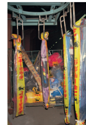
長野支店がスキー板を仕分けるために独自に開発した専用リフター
