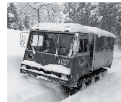
大雪の翌年に導入された走行用ベルト付きの雪上車(石打営業所、1985年)
