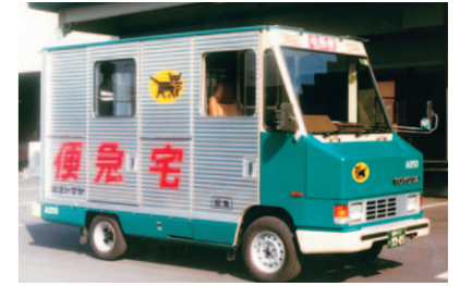
完成したウォークスルー試作車両第1号 (1981年8月。現在、羽田クロノゲート受付棟に展示)
