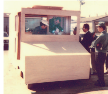
左のベンヤ板の車体に塗装した試作品 (1980年3月)
