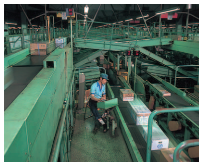
自動仕分機(スチールベルト方式、埼玉ベース)
